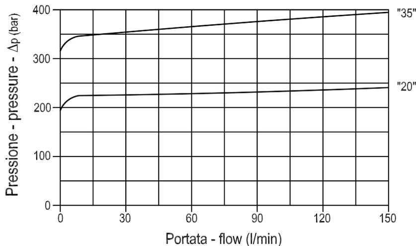
**Valvola di sequenza bilanciata ad azione diretta, montaggio in linea**
